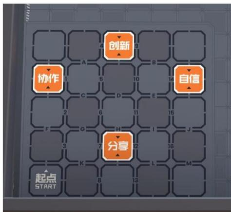
4. 比赛双方区域各有一个能量区，能量区放置有8个能量方块，能量区尺寸为182mm\*365mm，能量方块材质为EVA，尺寸为55mm\*55mm\*55mm，每个能量方块的四个面上有相应的精神能量文字，分别为创、新、协、作、自、信、分、享。
