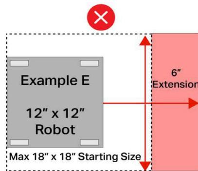
图 SG2-5：违规。机器人在其多个方向上扩展。
