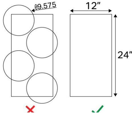
图 R19-1：自制塑料件须可容纳于单块 12” x24” 的塑料板内。
