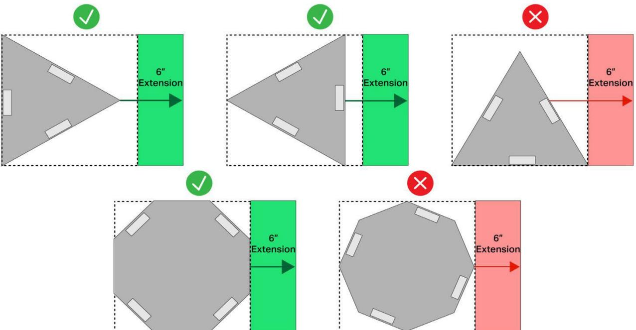
图 SG2-6：机器人的形状越不规则，就越难识别明确的“边”。尝试采用非传统设计的战队需要牢记，这种设计不会在验机环节获得任何区别的对待。
