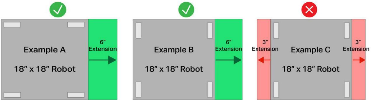
图 SG2-1：合规。机器人展开比合规起始尺寸 18' ' x18' ' 长 6' ' 。
