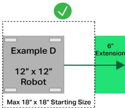
图 SG2-4：合规。起始尺寸小于 18 “x 18” 的机器人
