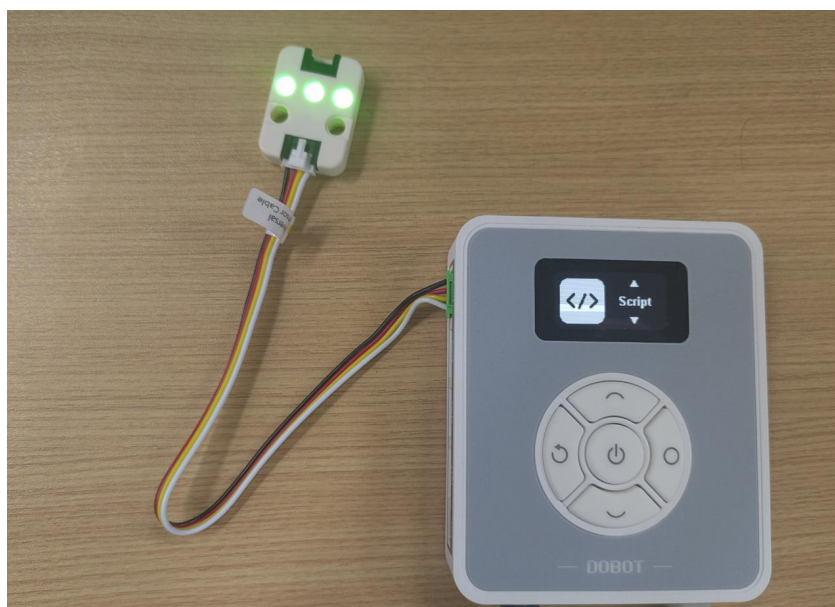
系统运行状态 LED 灯模块亮绿灯（图片仅供参考）
